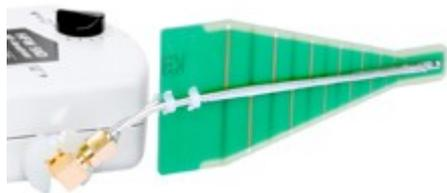
L'appareil de mesure possède une entrée pour connecter une mini antenne Log périodique, qui se retrouve être excellente pour localiser les sources de rayonnements de hautes fréquences de cette nature.
