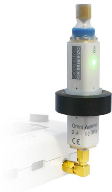
Il permet une identification des sources de rayonnements pulsés par l'analyse acoustique et possibilité d'alarme et une lecture des valeurs crêtes et de la valeur moyenne d'affichage (commutable).
