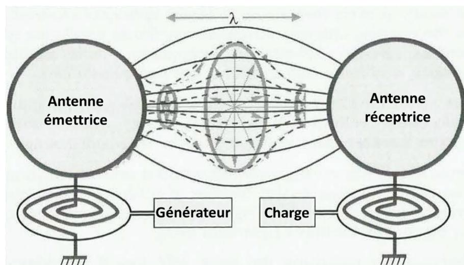
Dès que l'accord de résonance est réalisé entre émetteur et récepteur, une transmission d'énergie et d'information se fait sans fil au travers de l'air et un retour électrique se réalise par un « fil de terre » : il y a alors plus d'énergie en  $\mu$ Watts reçue sur le récepteur que d'énergie initialement
